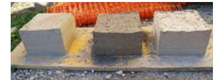
Ladrillo o bloque de tierra comprimido (BTC), material de elevada masa térmica
